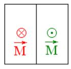
Рис.10. Направление намагниченности в соседних доменах в одноосной пленке. Вид сверху.
