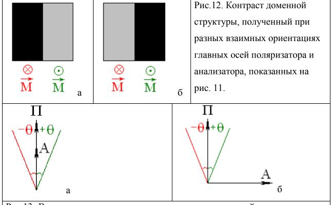
Рис.13 Варианты взаимного расположения главных осей поляризатора и анализатора и поворот плоскости поляризации света, прошедшего через домены с противоположной намагниченностью (контраст доменных границ).
