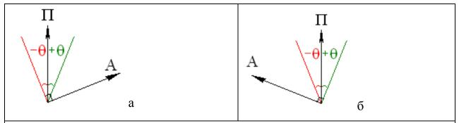
Рис.11 Варианты взаимного расположения главных осей поляризатора и анализатора и поворот плоскости поляризации света, прошедшего через домены с противоположной намагниченностью (контраст доменов).
