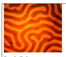
Рис.8. Лабиринтная доменная структура в пленке феррита-граната (период около 100 мкм)
