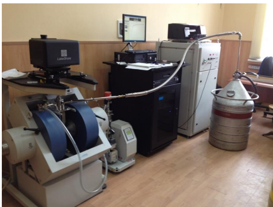
Рис. 13. Вибрационный магнитометр Lake Shore.
