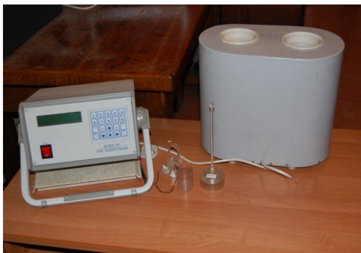
Рис. 14. Измеритель магнитной восприимчивости ИМВО-М
