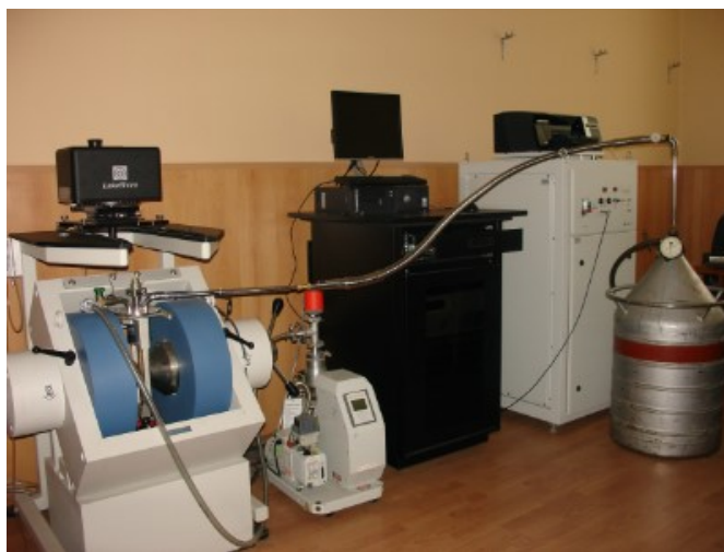
Рис. 11. Вибрационный магнитометр LakeShore на кафедре магнетизма Физического факультета МГУ
