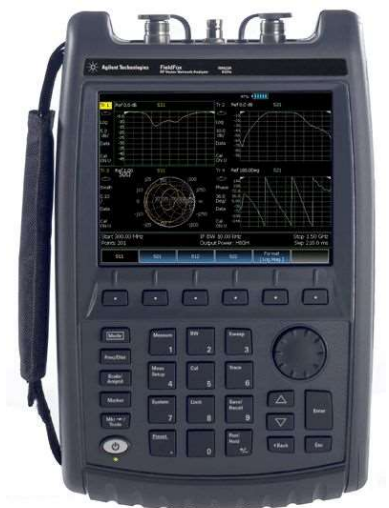
Рисунок 11. Векторный сетевой анализатор Agilent FieldFox N9923A [рисунок взят с сайта: http://www.keysight.com ]
