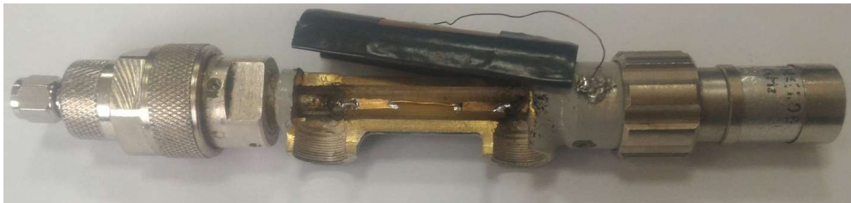
Рисунок 15. Изображение тестируемого устройства, к которому припаивается держатель с образцом (на этом рисунке на держатель припаян медный провод).
