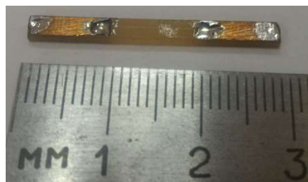
Рисунок 14. Держатель, к которому припаян образец (микропровод).
