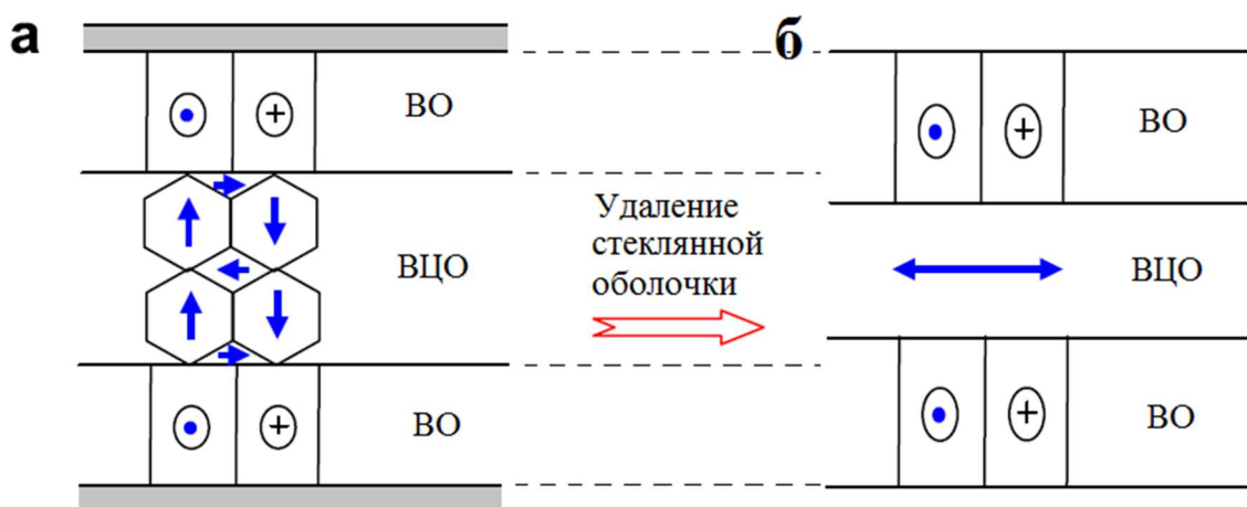
Рисунок 5. Схематическая иллюстрация доменной структуры типичного аморфного провода с отрицательной константой магнитострикции со стеклянной оболочкой: (а) провод со стеклянным покрытием; (б) провод после удаления стеклянной оболочки. ВО – внешняя оболочка; ВЦО – внутренняя цилиндрическая область. Рисунок взят из [12].
