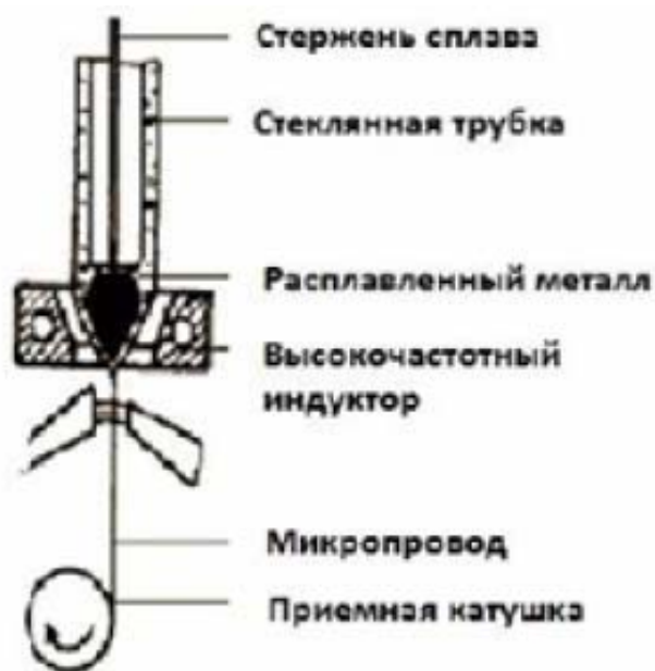
Рис 1. Получение аморфных микропроводов с помощью модернизированного метода Улитовского-Тейлора
