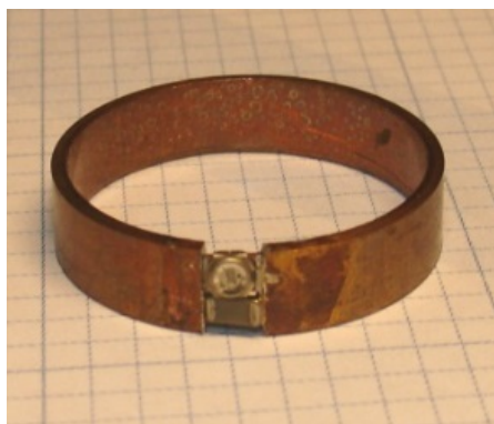
Рисунок 1 – Слева - пример метаатома в МГц диапазоне – расщепленный кольцевой резонатор с впаянной емкостью. Внешний диаметр кольца – 21 мм, размер щели – 2 мм, впаянная емкость C=330 пФ, резонансная частота \omega_0=50.9 МГц, добротность Q=91 . Справа - эквивалентный RLC -контур.
