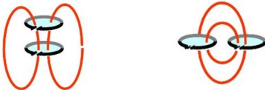
Рисунок 3 – Схематическое изображение положительного и отрицательного взаимодействия элементов магнитных метаматериалов (слева) в аксиальной и (справа) планарной конфигурациях, приводящего к возникновению магнитоиндуктивных волн.
