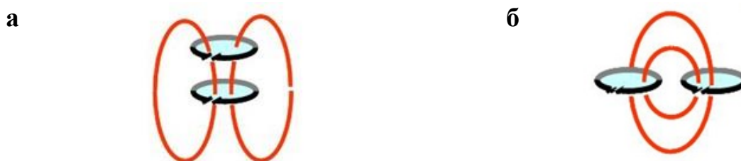
Рисунок 5 – Схематическое изображение взаимодействия элементов магнитных метаматериалов в аксиальной (а) и планарной (б) конфигурациях, приводящее к возникновению магнитоиндуктивных волн.
