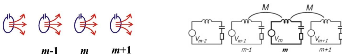
Рисунок 4 – Схема одномерной цепочки расщепленных колец (слева) и эквивалентных взаимодействующих LCR -контуров (справа).
