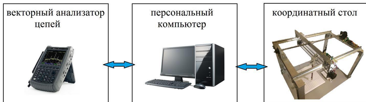
Рисунок 6 – Блок-схема автоматизированного стенда для топографирования электромагнитных полей метаповерхностей в МГц и ГГц диапазонах. Слева направо: векторный анализатор цепей, персональный компьютер, координатный стол [14].
