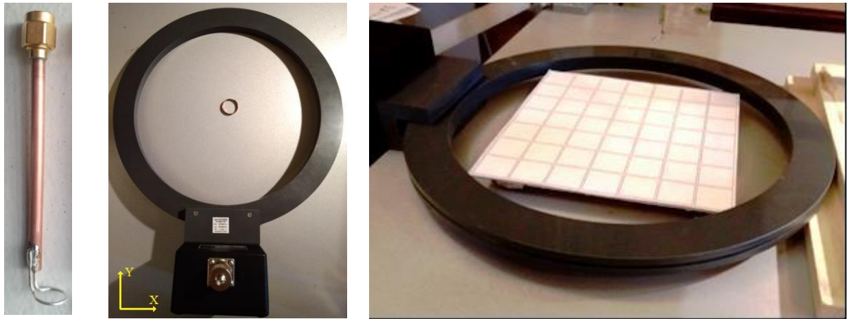
Рисунок 7 – Внешний вид антенн, использованных в работе. Антенна для локального возбуждения метаповерхности (а). Рамочная антенна для однородного возбуждения. Внешний диаметр 305мм, внутренний 245мм. Антенна вместе с резонансным элементом в центре (б) и вместе с подложкой для метаповерхности 7*7 мета-атомов (размеры ячейки 24*24мм) (в).
