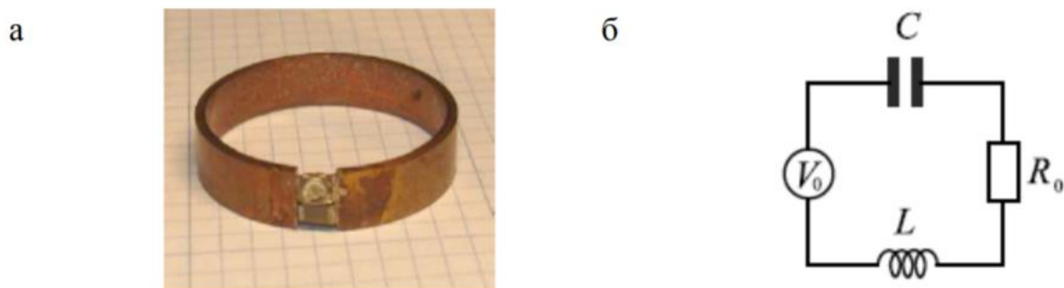
Рисунок 21 – (а) Пример атома в МГц диапазоне – расщепленное резонансное кольцо с впаянной емкостью. Внешний диаметр кольца. (б) Эквивалентный LCR-контур [13].
