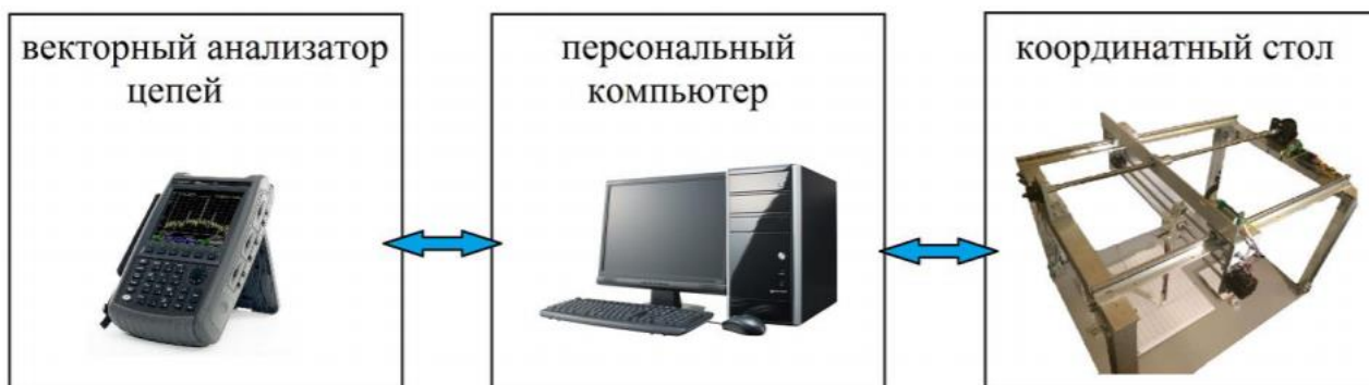
Рисунок 26 – Блок-схема автоматизированного стенда для топографирования электромагнитных полей метаповерхностей в МГц и ГГц диапазонах. [24]
