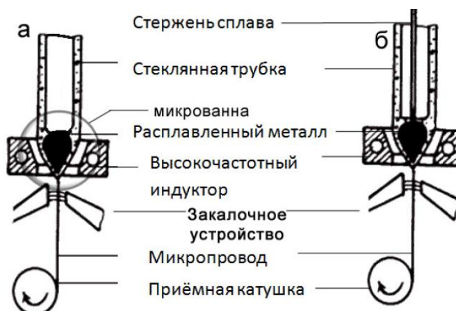
Рисунок 1.2. Получение металлического микропровода в стеклянной оболочке по методу А. Улитовского:
