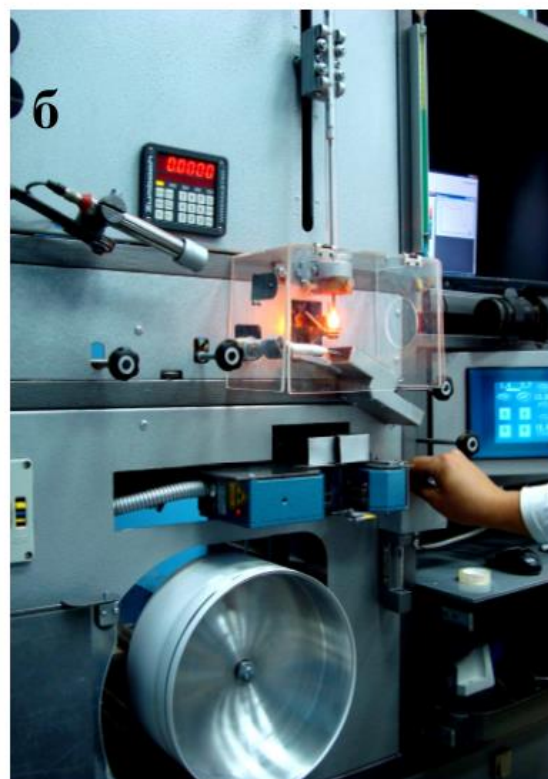
Рис. 1.1-2 Лабораторная установка для получения микропровода методом Улитовского-Тейлора: принципиальная схема (а); общий вид (б)[6]
