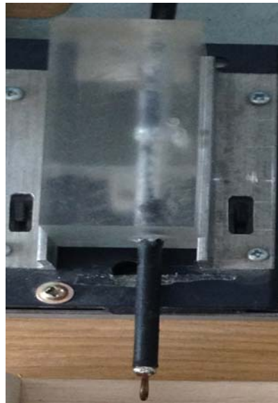
Рис. 10. Внешний вид приемной антенны: коаксиальный кабель, внутренний провод которого запаян на внешнюю оплетку, образуя кольцо радиусом 3 мм
