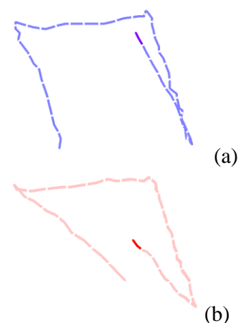
Рис. 27 Траектории движения частиц, под действием токов 2А, текущего по немагнитным проволокам. (а) – траектория синей частицы, (б)- траектория красной частицы.
